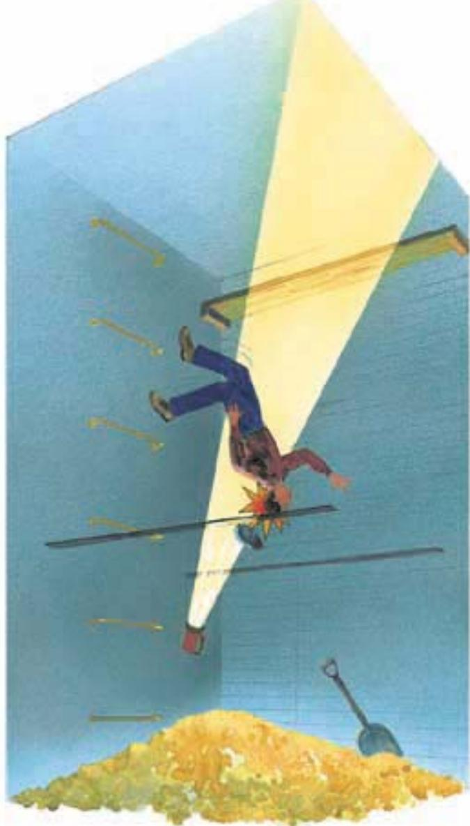
Les installations doivent être conformes aux exigences du *Règlement sur la santé et la sécurité du travail*. La distance maximale acceptable entre les échelons permettant de descendre dans le silo est de 30 cm. L'espace entre le pied et la paroi arrière ne peut être en deçà de 15 cm.
